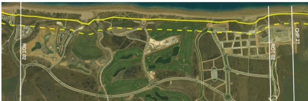
Figura 2. Ortofoto con la delimitación del DPMT (desde el mar hasta la línea continua) de la ZSP (desde la línea continua hasta la discontinua). Costa Ballena en Rota y Chipiona (Cádiz).
