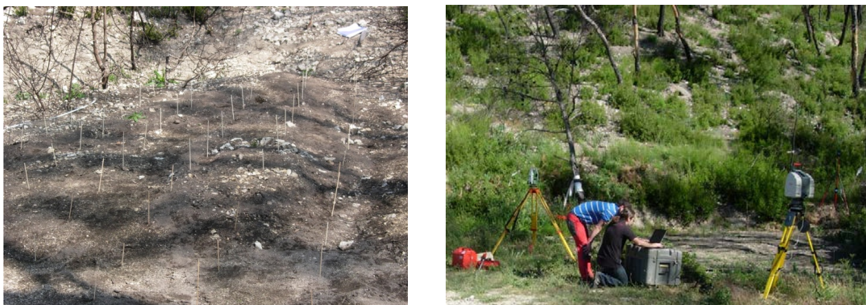
Figura 4. Control y monitorización de cuencas experimentales, mediante varillas de erosión (izquierda) y láser escáner (derecha).
